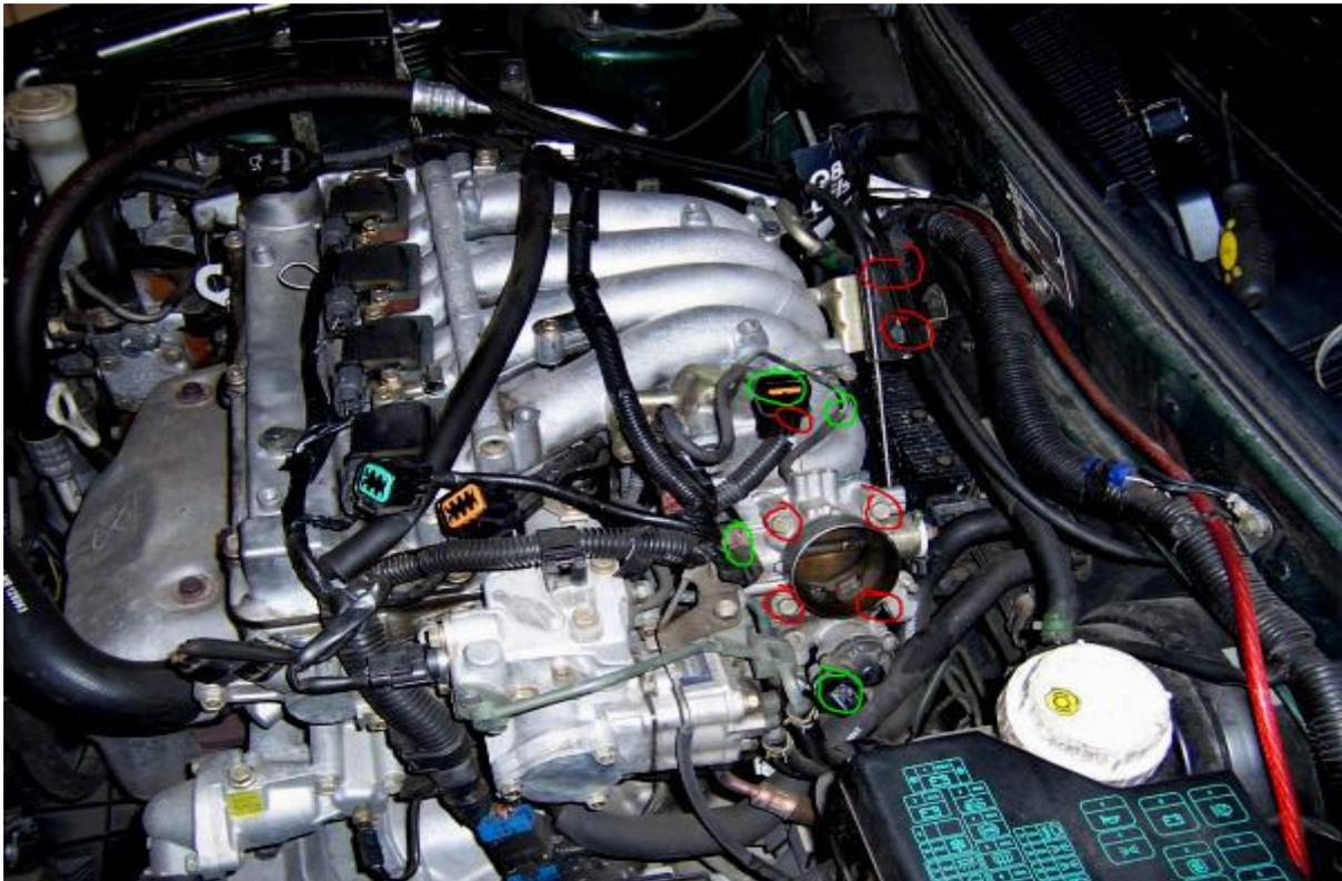
Ich habe euch mit grün die Stecker und Schläuche markiert. Rot sind die Schrauben. Also zuerst alle Stecker und den einen kleinen Schlauch oberhalb der Drosselklappe abziehen. Dann den AGR-Ventil-Stecker abschrauben, das ist oben der orangefarbene. Dies ermöglicht euch später einen besseren Zugang.
